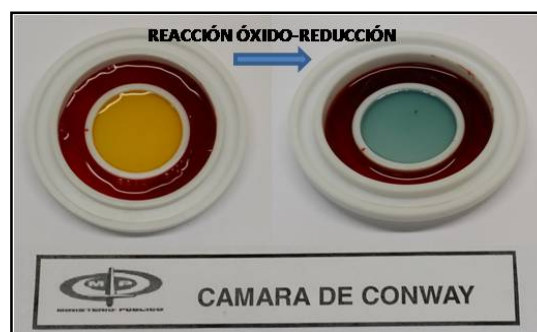
Figura 1: Cámara de Conway con el proceso de micro-difusión.
